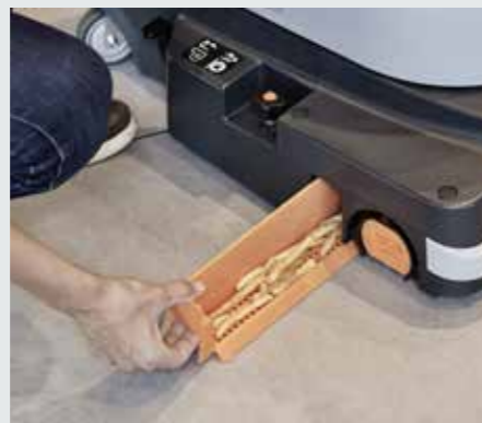
A szemetgyűjtő tartály könnyen üríthető és tisztítható
